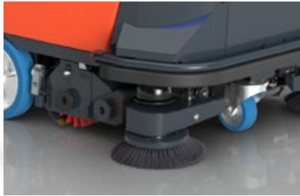
원통형 브러시와 사이드 브러시로 건식+습식 청소 가능 한 번의 작업으로 자동청소를 수행할 수 있습니다.
